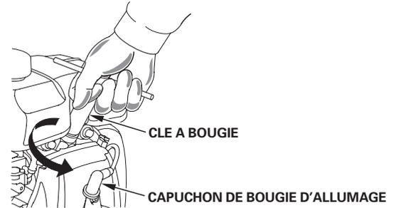
3. Contrôler la bougie. La remplacer si elle est endommagée ou très encrassée, si sa rondelle d'étanchéité est en mauvais état ou si son électrode est usée.
