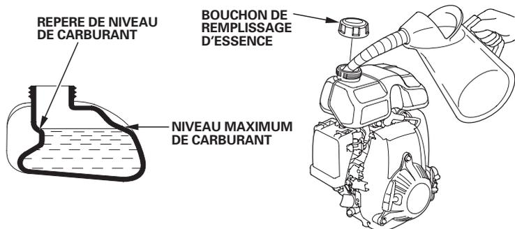
3. Faire le plein avec précaution pour éviter de renverser du carburant. Ne pas remplir le réservoir de carburant complètement. Dans certaines conditions d'utilisation, il peut être nécessaire de baisser le niveau du carburant. Après avoir fait le plein, resserrer le bouchon de remplissage de carburant à fond.
