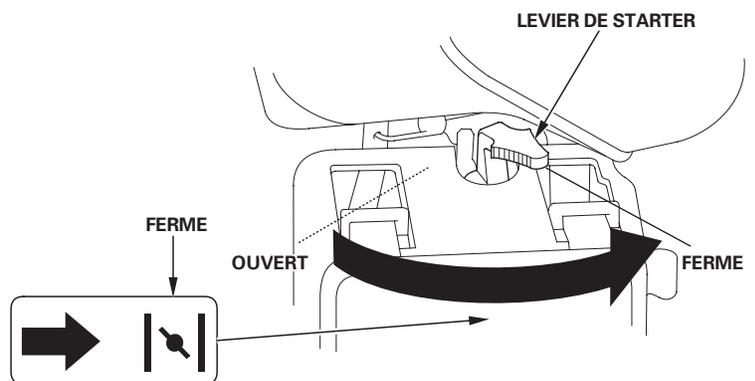
Pour remettre en marche un moteur chaud, laisser le levier de starter sur la position OUVERT.
