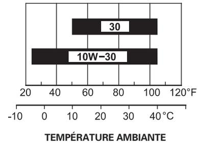
Une huile SAE 10W-30 est recommandée pour l'utilisation générale. Les autres viscosités indiquées dans le tableau peuvent être utilisées lorsque la température moyenne du lieu d'utilisation se trouve dans la plage indiquée.
