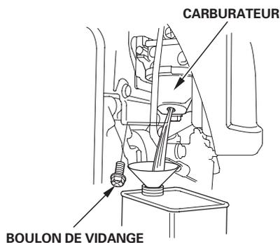
3. Après avoir vidangé tout le carburant dans le récipient, reposer le boulon de vidange (type à carburateur avec boulon de vidange seulement). Serrer le boulon de vidange ou la vis de vidange à fond.
