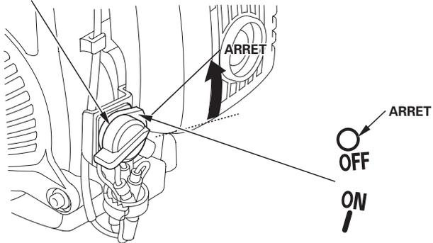
3. Placer le levier du robinet de carburant sur la position ARRET.
