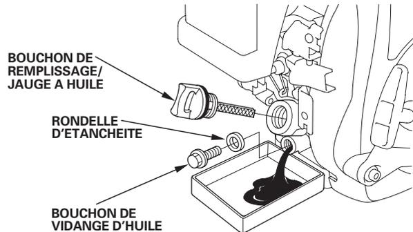
3. Avec le moteur à l'horizontale, remplir d'huile recommandée (voir page 7 ) jusqu'au repère de limite maximum (bord inférieur de l'orifice de remplissage d'huile).
