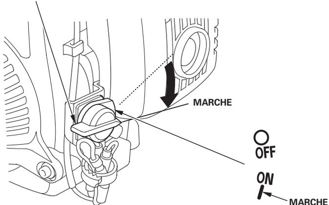
4. Tirer doucement la poignée de lancement jusqu'à ce que l'on ressente une résistance, puis la tirer d'un coup sec. Ramener doucement la poignée de lancement en arrière.
