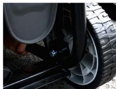
2. Insérez la goupille R dans le trou situé à l'extrémité de l'arbre de la roue afin d'empêcher la roue de se détacher.
