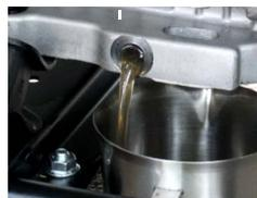
4. Remplissez l'huile au niveau correct et resserrez la jauge de niveau.
