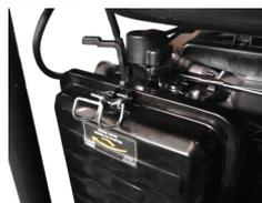
2. Nettoyez l'élément du filtre en mousse avec un solvant de nettoyage et laissez-le sécher à l'air. Mettez quelques gouttes d'huile sur le filtre.
