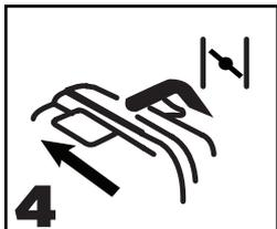
PULL THE CHOKE LEVER TO THE CLOSED POSITION.
